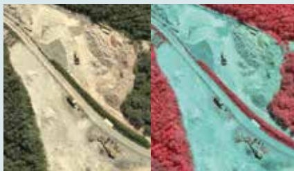
Ortofotos de alta resolução em RGB/FCIR (Leica RCD30) – modelo digital de superfície a partir de imagens aéreas
